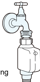
ống cấp nước an toàn
